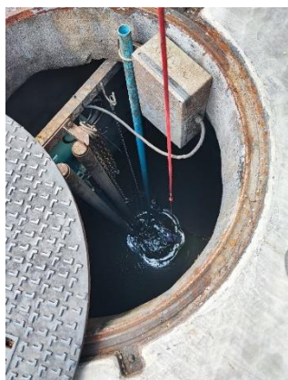
รูปที่ 3.31 ภาพแสดงการเก็บตัวอย่างน้ำจุดที่ 3 คุณภาพน้ำก่อนการบำบัด บ่อปรับสภาพสมดุล ระบบบำบัดน้ำเสียอาคาร B
